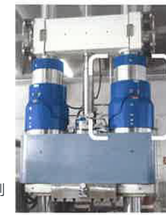
油圧式高圧プレスでの採用例 400 トンの加圧力
