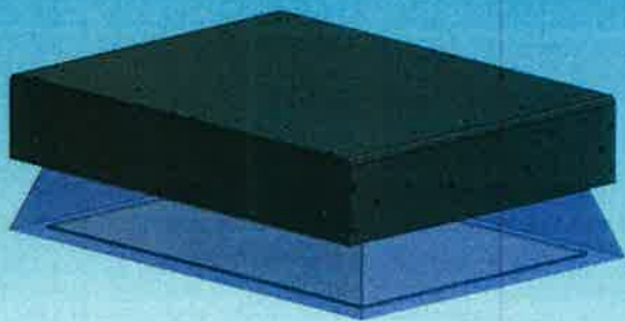
液晶パネルへのカバーガラスの接着（全面）
